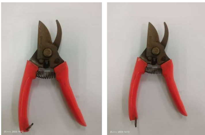
ภาพที่ 19 แสดงลักษณะของกรรไกรตัดกิ่งไม้ที่เกิดสนิม
