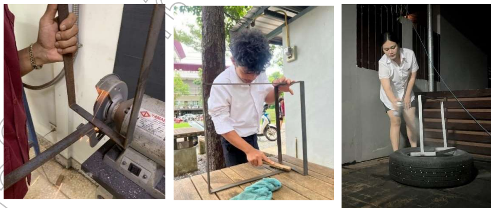
ภาพที่ 3 การเจียรเพื่อเก็บความเรียบร้อย การทำความสะอาดชุดคานเหล็กและการพ่นสีกันสนิม
