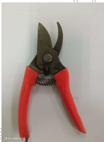
ภาพที่ 20 การกำจัดสนิมด้วยเครื่องเจียรแปรงลวดไฟฟ้า ซึ่งในซอกมุมจะไม่สามารถกำจัดสนิมได้
