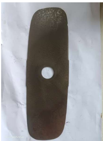
ภาพที่ 16 การกำจัดสนิมใบมีดเครื่องตัดหญ้าด้วยเครื่องเจียรปรังลวดไฟฟ้า ซึ่งในขอกมมจะไม่สามารถกำจัดสนิมได้
