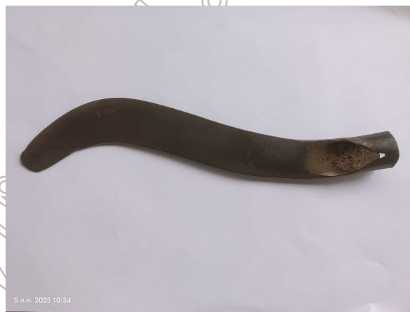
ภาพที่ 12 การกำจัดสนิมของมิตดาหยั่วด้วยเครื่องเจียรแปลงลดไฟฟ้า ซึ่งในซอกมุมจะไม่สามารถกำจัดสนิมได้
