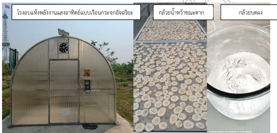
ภาพที่ 1 โรงอบแห้งพลังงานแสงอาทิตย์แบบเรือนกระจกอัจฉริยะ
