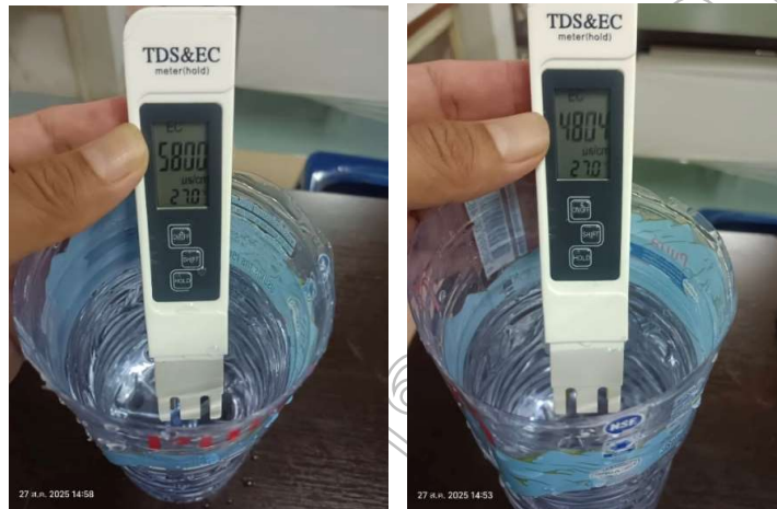
ภาพที่ 6 แสดงการเปรียบเทียบค่า EC ของเกลือแอกกับเบกกิ้งโซดา
