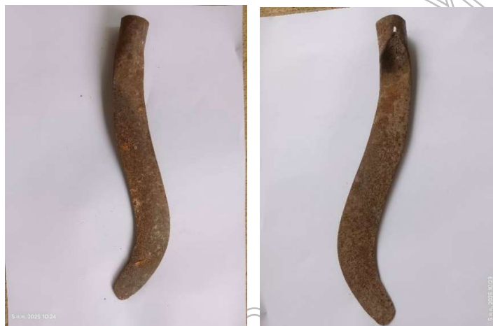
ภาพที่ 11 แสดงลักษณะของมิตดาหยั่วที่เกิดสนิม
