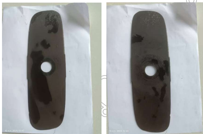
ภาพที่ 18 แสดงการกำจัดสนิมของไบมิดเครื่องตัดหญ้าด้วยระบบอิเล็กทรอนิกส์
