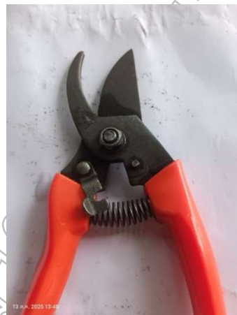
ภาพที่ 22 แสดงการกำจัดสนิมของกรรไกรตัดกิ่งไม้ด้วยระบบอิเล็กทรอนิกส์
