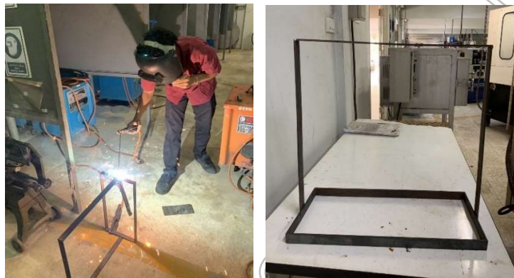
ภาพที่ 2 แสดงการจัดสร้างชุดคานเหล็กสำหรับใช้แขวนเครื่องมือหรือชิ้นงานเพื่อใช้จุ่มแช่ในถังสารละลาย
