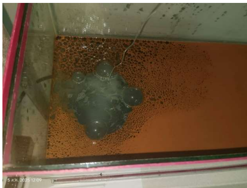
ภาพที่ 21 แสดงการทดสอบการกำจัดสนิมของกรรไกรตัดกิ่งไม้
