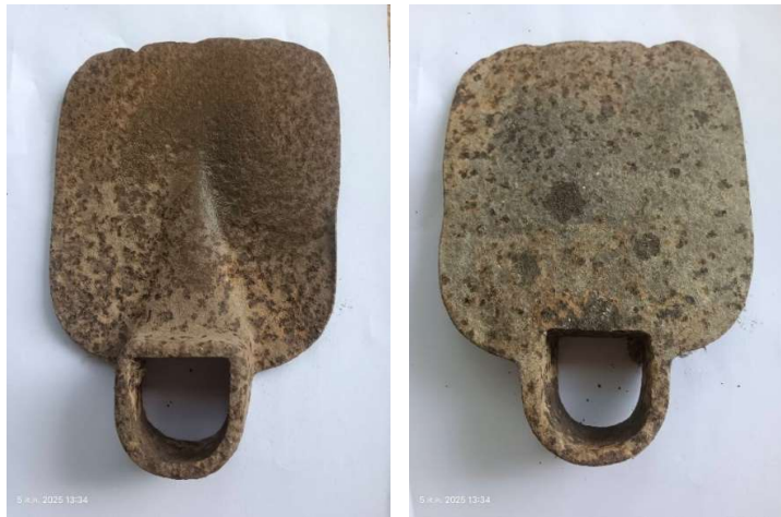
ภาพที่ 7 แสดงลักษณะของจอบที่เกิดสนิม
