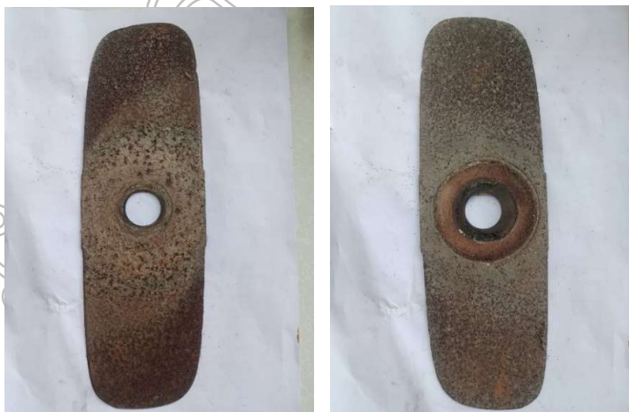
ภาพที่ 15 แสดงลักษณะของใบมีดเครื่องตัดหญ้าที่เกิดสนิม
