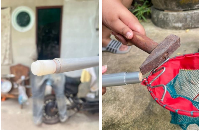
ภาพที่ 2 แสดงชุดข้อต่อที่อยู่ภายในด้ามของไม้สอย และการติดตั้งชุดตะกร้อเข้ากับปลายของด้ามไม้สอย
