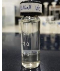
ภาพที่ 7 น้ำมันไบโอดีเซลที่ผลิตจากน้ำมันเมล็ดในปาล์มบริสุทธิ์ด้วยตัวเร่งปฏิกิริยา KI/CaO ทำปฏิกิริยาที่อุณหภูมิ 60°C เวลา 2 ชั่วโมง
