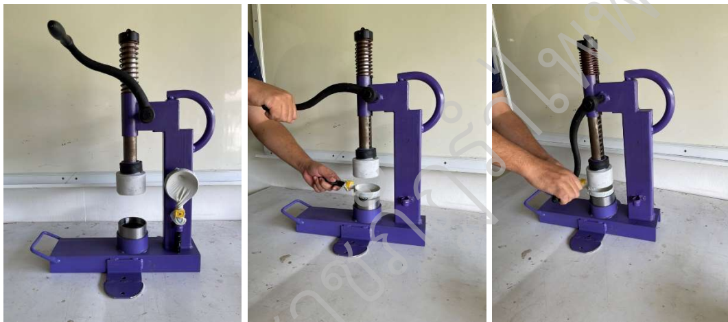
ภาพที่ 5 เครื่องอัดก้อนอิเอ็มบอลของกลุ่มวิสาหกิจชุมชนเกษตรเพื่อสุขภาพบ้านปลิว
