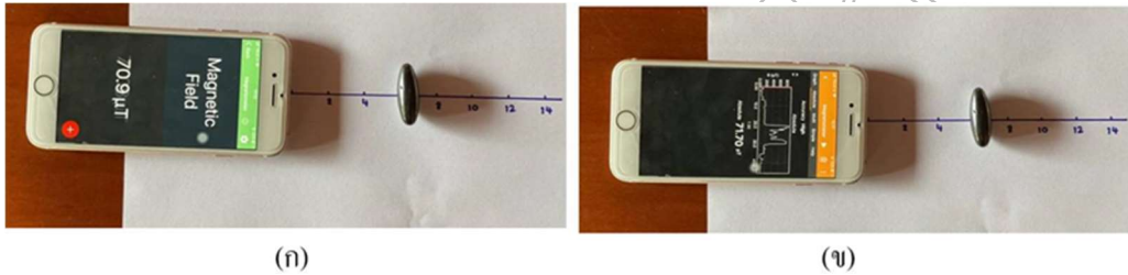
ภาพที่ 4 การติดตั้งอุปกรณ์ทดลองวัดค่าสนามแม่เหล็กแบบ 2 ขั้วของแท่งแม่เหล็กถาวรรูปทรงต่าง ๆ ที่เป็นฟังก์ชันของระยะห่างวัดโดยใช้เซนเซอร์ Magnetometer บน iPhone 7 ที่ติดตั้งแอปพลิเคชัน Physics Toolbox Sensor Suite และ (ข) Phyphox ในการวัดค่าความเข้มสนามแม่เหล็ก
