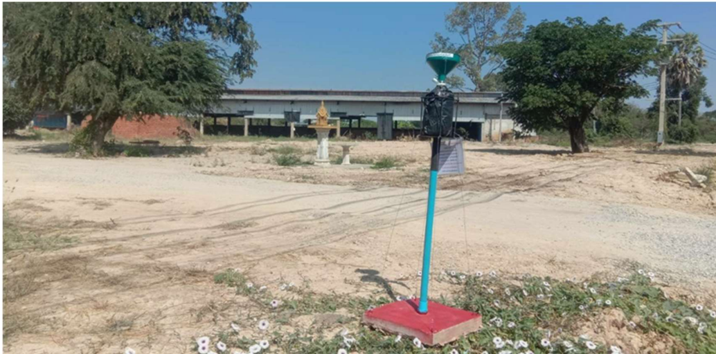
ภาพที่ 2 อุปกรณ์สำหรับเก็บตัวอย่างฝุ่นตกตั้งในจุดเก็บตัวอย่าง โรงงานเผาอิฐมอญตำบลบางมะฝ่อ
