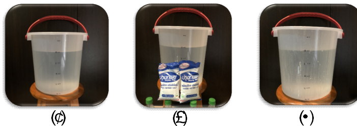
ภาพที่ 3 ถังน้ำที่วัดระดับความสูงและเติมของไหลในถัง (ก) น้ำ (ข) น้ำเกลือ และ (ค) น้ำอัดลมสไปร์ท
