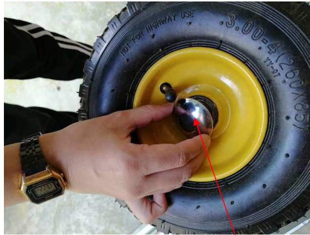
ติดตั้งล้อมยางเข้ากับแกนเพลลา
