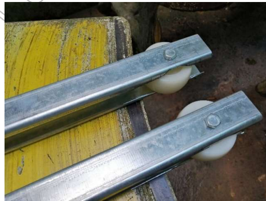
ภาพที่ 6 แสดงลักษณะการติดตั้งชุดล้อหน้าของรถเข็นขนส่งผลไม้
