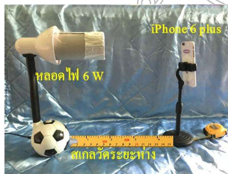
ภาพที่ 1 การติดตั้งชุดอุปกรณ์การทดลองวัดค่าความส่องสว่างของหลอดไฟขนาด 6 วัตต์
