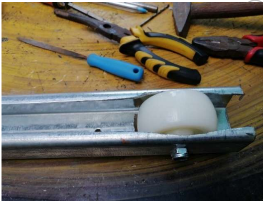
ภาพที่ 6 แสดงลักษณะการติดตั้งชุดล้อหน้าของรถเข็นขนส่งผลไม้
