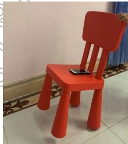
ภาพที่ 1 การทดลองหาค่าสัมประสิทธิ์ความเสียดทานสถิตสูงสุดระหว่างสมาร์ทโฟนกับเก้าอี้พลาสติก
