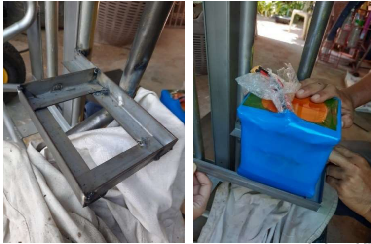
ภาพที่ 11 แสดงการจัดสร้างฐานรองรับแบตเตอรี่และการติดตั้งแบตเตอรี่
