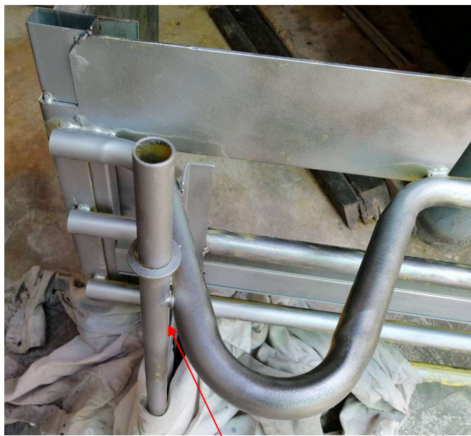
ท่อเหล็กกลมจัดสร้างเป็นเพลาล้อ
