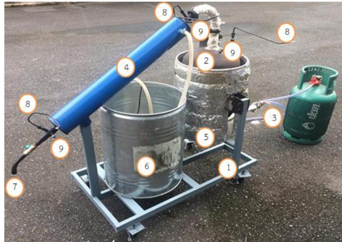
ภาพที่ 1 ลักษณะของส่วนประกอบการผลิตน้ำมันเชื้อเพลิงจากขยะพลาสติก
