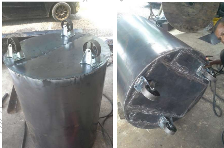
ภาพที่ 6 และ 7 แสดงการติดตั้งล้อเหล็กจำนวน 3 ชุด สำหรับเคลื่อนย้าย
