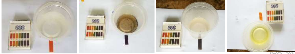
ภาพที่ 2 การทำสารช่วยติดสี โดยการวัดค่าความเป็นกรดต่าง
