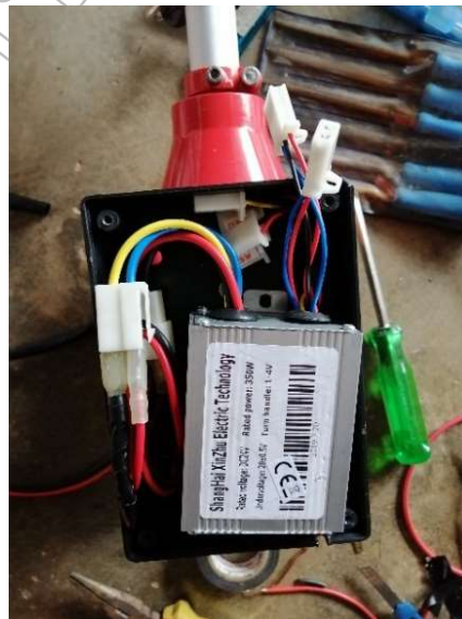
ภาพที่ 10 และ 11 แสดงการติดตั้งมือปิดเร่งและกล่องคอนโทรลเพื่อใช้ควบคุมการทำงานของเครื่องตัดหญ้า
