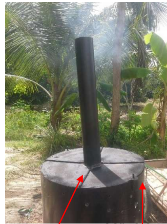
ปิดฝาเตาและปล่องควัน ห่วงที่ฝาปิดใส่เข้ากับสลัก
