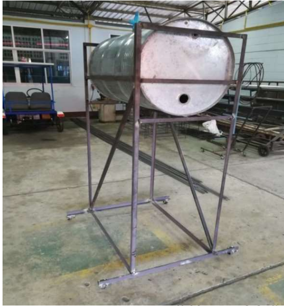
ภาพที่ 3 ชุดโครงสร้างส่วนประกอบของเครื่องตะบันน้ำโดยมีหมายเลขและรายละเอียดดังภาพที่ 4 และตารางที่ 1
