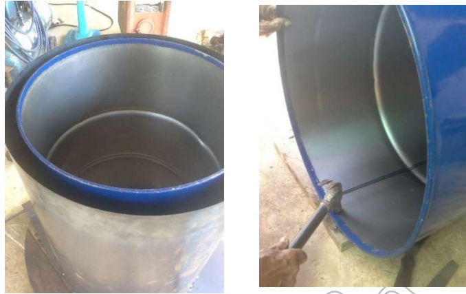
ภาพที่ 8 และ 9 แสดงลักษณะของถังทั้งสองใบและการปรับเก็บขอบถังที่มีรอยคม
