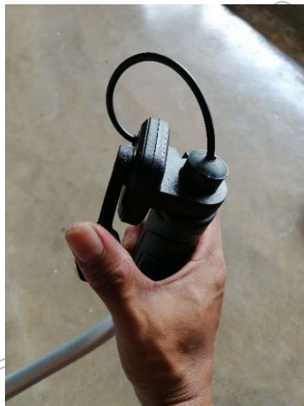
ภาพที่ 10 และ 11 แสดงการติดตั้งมือปิดเร่งและกล่องคอนโทรลเพื่อใช้ควบคุมการทำงานของเครื่องตัดหญ้า
