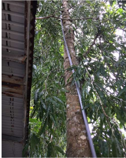
ภาพที่ 6 ติดตั้งระดับน้ำที่จะส่งขึ้นไปตามระยะการทดสอบ
