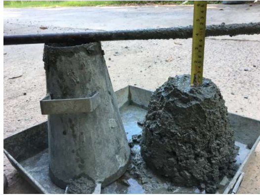
ภาพที่ 2 ตัวอย่างการวัดค่ายุบตัวของคอนกรีต (Slump Test)
