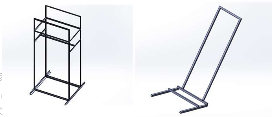
ภาพที่ 2 ออกแบบฐานเครื่องตะบันน้ำและฐานตั้งรองรับถังน้ำ
