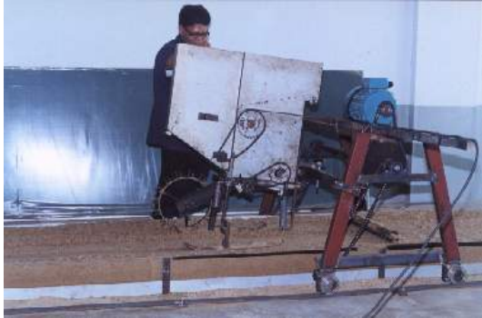
ภาพที่ 1 ต้นแบบเครื่องปลุกกระเทียมแบบงานหยอดแนวตั้ง
