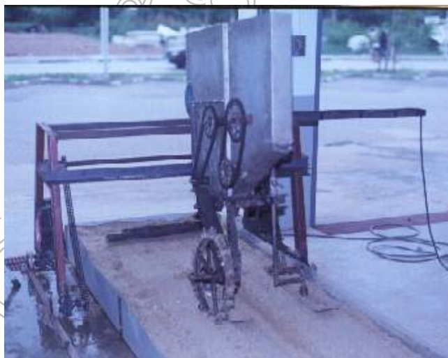
ภาพที่ 3 ติดตั้งเครื่องปลุก เพื่อทดสอบในอุปกรณ์ทดสอบชุดอ่างรางดิน
