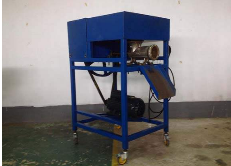
ภาพที่ 2 เครื่องอัดเม็ดปุ๋ยจากทางใบปาล์ม
