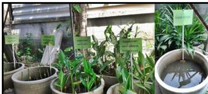
ภาพที่ 2 การบำบัดน้ำเสียทางด้านชีวภาพ (การบำบัดด้วยกกกลมและพุทธรักษา)
