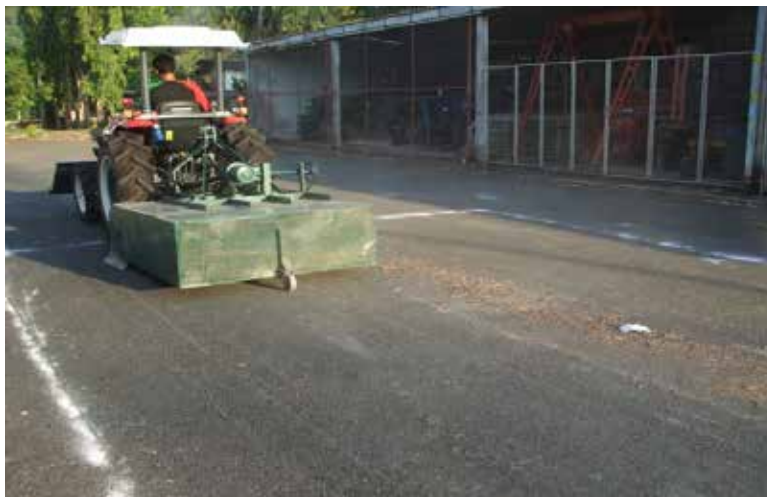
ภาพที่ 5 การทดสอบการทำงานของเกียร์ LOW 4 และ HIGH 1
