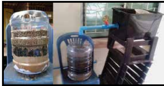
ภาพที่ 1 การบำบัดน้ำเสียทางด้านกายภาพ (การดักไขมันและเศษอาหาร ด้วยการกรองผ่านชั้นหินหยาบ หินละเอียด ถ่านทุบละเอียด ทรายหยาบ ทรายละเอียด และผ้าขาวบาง)
