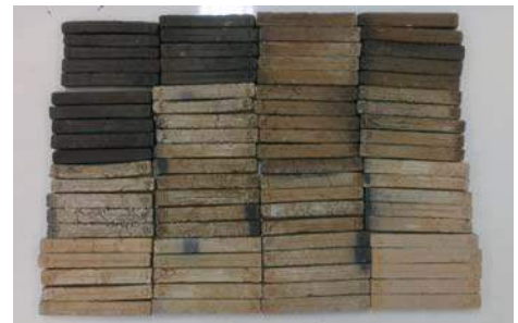
ภาพที่ 11 ชิ้นทดสอบผ่านการเผา 1,100 องศาเซลเซียส
