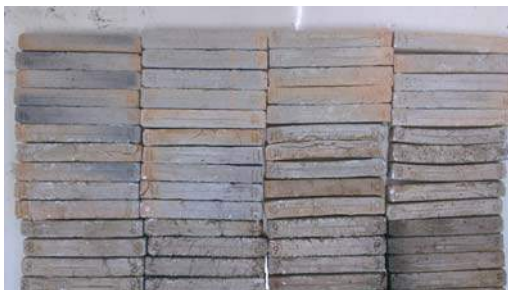
ภาพที่ 10 ชิ้นทดสอบผ่านการเผา 950 องศาเซลเซียส
