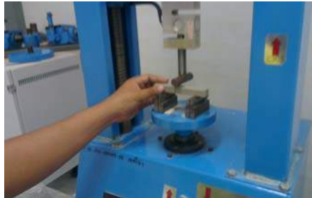
ภาพที่ 5 การทดสอบสมบัติความแข็งแรงด้วยเครื่องทดสอบแรงกด
