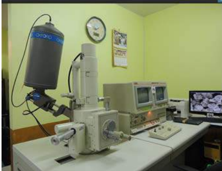
ภาพที่ 8 เครื่องสแกนนิ่งอิเล็กตรอนไมโครสโคป ภาพที่ 9 ชิ้นงานทดสอบถ่ายด้วยเครื่องสแกนนิ่งอิเล็กตรอนไมโครสโคป
