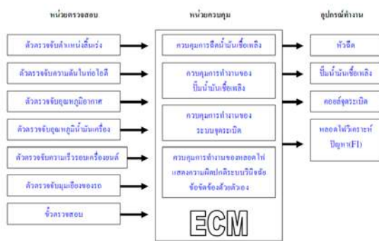
ภาพที่ 5 แผนผังการทำงานของระบบควบคุมอิเล็กทรอนิกส์
