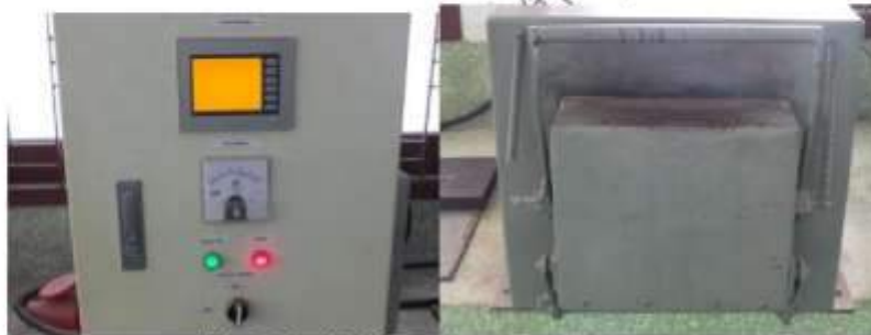
รูปที่ 1 ชุดควบคุมด้วยระบบ PID และเตาอบชุบเหล็กกล้า
