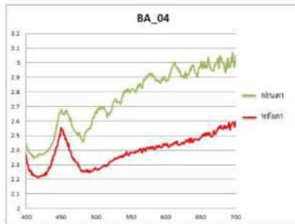
ภาพที่ 5 สเปกตรัมการดูดกลืนแสงของพอลิเมอร์เงินเข้มตัวอย่างที่ BA_04 ก่อนเผาและหลังเผาที่อุณหภูมิ 1500°C
