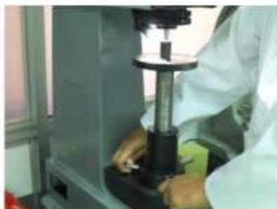
รูปที่ 18 การวัดค่าความแข็งกับเหล็กกล้าที่ผ่านการอบชุบ
