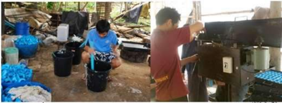
ภาพที่ 1 การกวนสบู่ กระบวนการเดิม กวนด้วยมือ และกระบวนการใหม่กวนด้วยเครื่อง ที่มา: นพรัตน์ พันธวาทิ และณัชชา สมจันทร์, 2559
