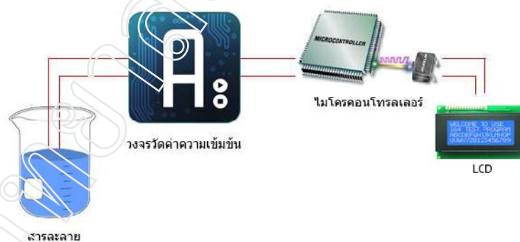
ภาพที่ 3 การทดลองเปรียบเทียบค่าความเข้มข้นโดยใช้ไมโครคอนโทรลเลอร์อ่านค่าการทดลอง
