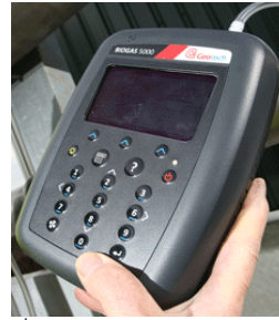
รูปที่ 2 เครื่องวัดสัดส่วนก๊าซชีวภาพ BIOGAS 5000
