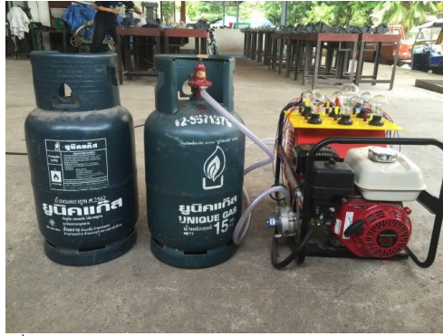
รูปที่ 2 เครื่องต้นแบบการผลิตกระแสไฟฟ้าขนาดเล็กด้วยก๊าซชีวภาพ
