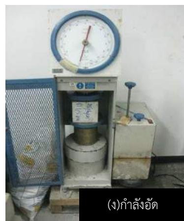
รูปที่ 2 ขั้นตอนการทดสอบ (ก)การไหลแผ่, (ข)การไหลผ่าน, (ค)การไหลในแนวตั้ง และ (ง)กำลังอัด
