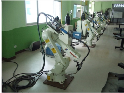
ภาพที่1 หุ่นยนต์แขนกลยี่ห้อ Kawasaki รุ่น RA10N
