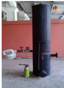
รูปที่ 3 เตาเผาชีวมวลแบบแก๊สซิฟิเคชันขนาดเล็กชนิดเชื้อเพลิงไหลลง
