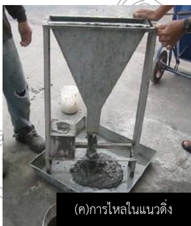
รูปที่ 2 ขั้นตอนการทดสอบ (ก)การไหลแผ่, (ข)การไหลผ่าน, (ค)การไหลในแนวตั้ง และ (ง)กำลังอัด
