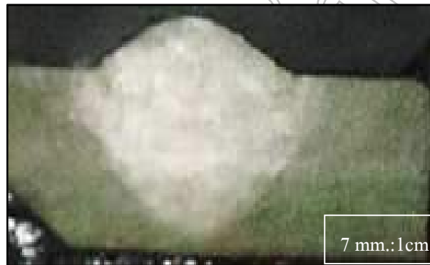
ภาพที่ 5 หน้าตัดเหล็กกล้าคาร์บอนเกรด S45C
