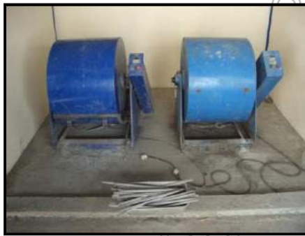
รูปที่ 1 การบดไม้ซุงด้วยเครื่องลอสแอนเจลีส (Los Angeles Machine)
