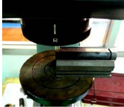
รูปที่ 4 ชิ้นทดสอบแบบจอมินี้ขณะทำการทดสอบความแข็งด้วยเครื่องทดสอบความแข็งแบบร็อกเวลล์
