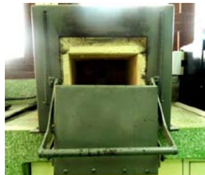
รูปที่ 3 (ซ้าย) ชิ้นทดสอบแบบจอมินี่ขณะทำการทดสอบบนอุปกรณ์ทดสอบ (ขวา) เตาอบที่ใช้ในการทดสอบ
