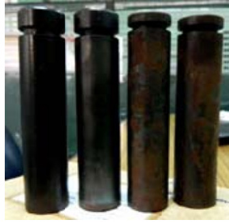
รูปที่ 2 (ซ้าย) ลักษณะของชิ้นทดสอบ (ขวา) ขนาดของชิ้นทดสอบแบบจอมินี่
