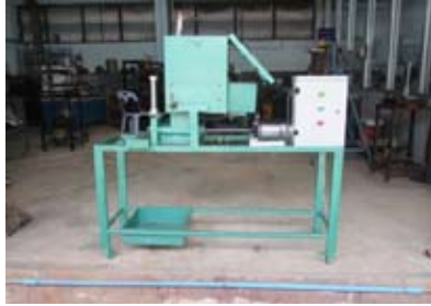
รูปที่ 3 เครื่องอัดกากกาแฟควบคุมด้วย PLC
