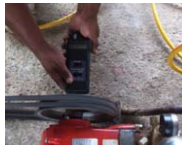
ภาพที่ 8 การวัดความเร็วรอบเพลาคู่มือเครื่องพ่นยา
