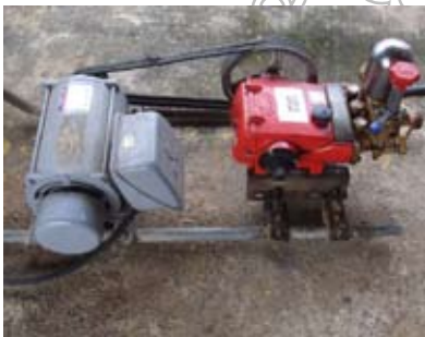
ภาพที่ 1 การใช้มอเตอร์ 1 เฟส ขนาด 2 แรงม้าเป็นต้นกำลัง
