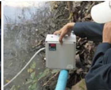
ภาพที่ 3 การเก็บตัวอย่างแก๊สชีวภาพและตัวอย่างในร่องสวนในพื้นที่ตัวอย่าง
