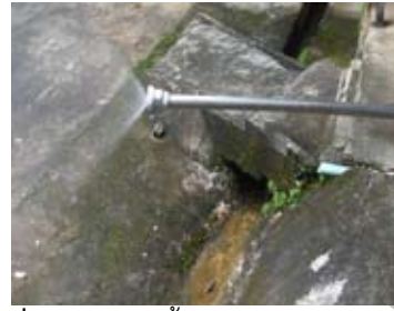
ภาพที่ 4 การปรับตั้งการฉีดละอองของหัวฉีด
