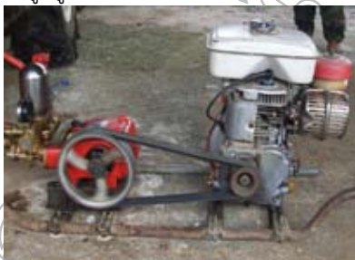
ภาพที่ 7 การใช้เครื่องยนต์เบนซินสูบเดียว ขนาด 2 แรงม้าเป็นต้นกำลัง
