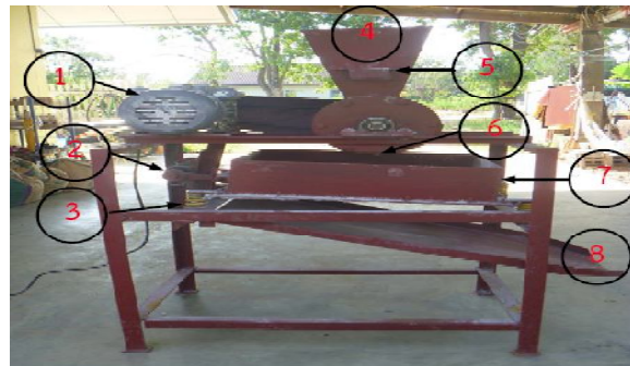
ภาพที่ 7 ชุดตีดินก้อน, เครื่องย่อย-เครื่องบด และเครื่องร่อน ให้อยู่ในเครื่องเดียวกัน ความละเอียดดิน 75 ไมครอน
