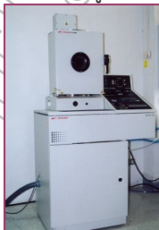
รูปที่ 1 ระบบระเหยสารด้วยลำอิเล็กตรอน
