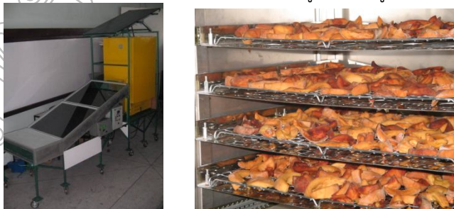
ภาพที่ 3 แสดงลักษณะเครื่องอบแห้งที่พัฒนาขึ้น และกระท้อนแช่อิ่มที่อยู่ในตู้อบ
