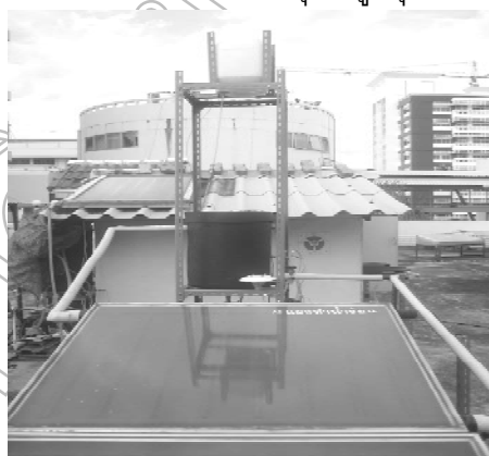
รูปที่ 1 เครื่องผลิตไบโอดีเซลโดยใช้พลังงานรังสีอาทิตย์เป็นพลังงานเสริมสำหรับการใช้งานในชนบท
