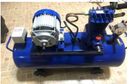
ภาพที่ 6 มอเตอร์ปั๊มลมพลังงานแสงอาทิตย์
