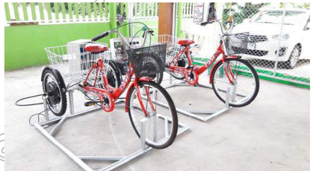
ภาพที่ 5 โครงสร้างจักรยานพร้อมจักรยานปั่นกระแสไฟฟ้า
