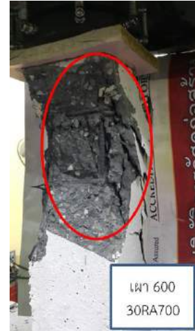
ภาพที่ 8 แสดงการวิบัติของเสาคอนกรีตเสริมเหล็กผสมเถ้าแกลบบดละเอียดร้อยละ 30 หลังการเผา
