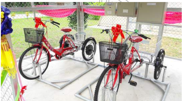
ภาพที่ 7 จักรยานปั่นร่วมกับพลังงานแสงอาทิตย์เพื่อผลิตกระแสไฟฟ้า
