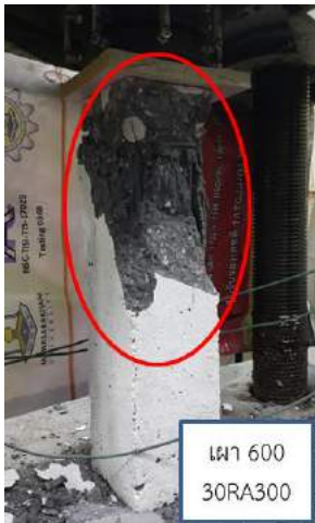
ภาพที่ 8 แสดงการวิบัติของเสาคอนกรีตเสริมเหล็กผสมเถ้าแกลบบดละเอียดร้อยละ 30 หลังการเผา
