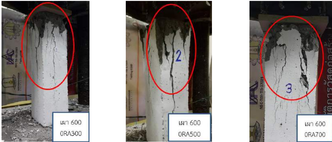
ภาพที่ 5 แสดงการวิบัติของเสาคอนกรีตเสริมเหล็กควบคุมหลังการเผา
