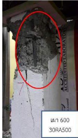
ภาพที่ 8 แสดงการวิบัติของเสาคอนกรีตเสริมเหล็กผสมเถ้าแกลบบดละเอียดร้อยละ 30 หลังการเผา
