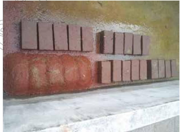
ภาพที่ 4 ภาพถ่ายอิฐดินดิบหลังแช่น้ำ
